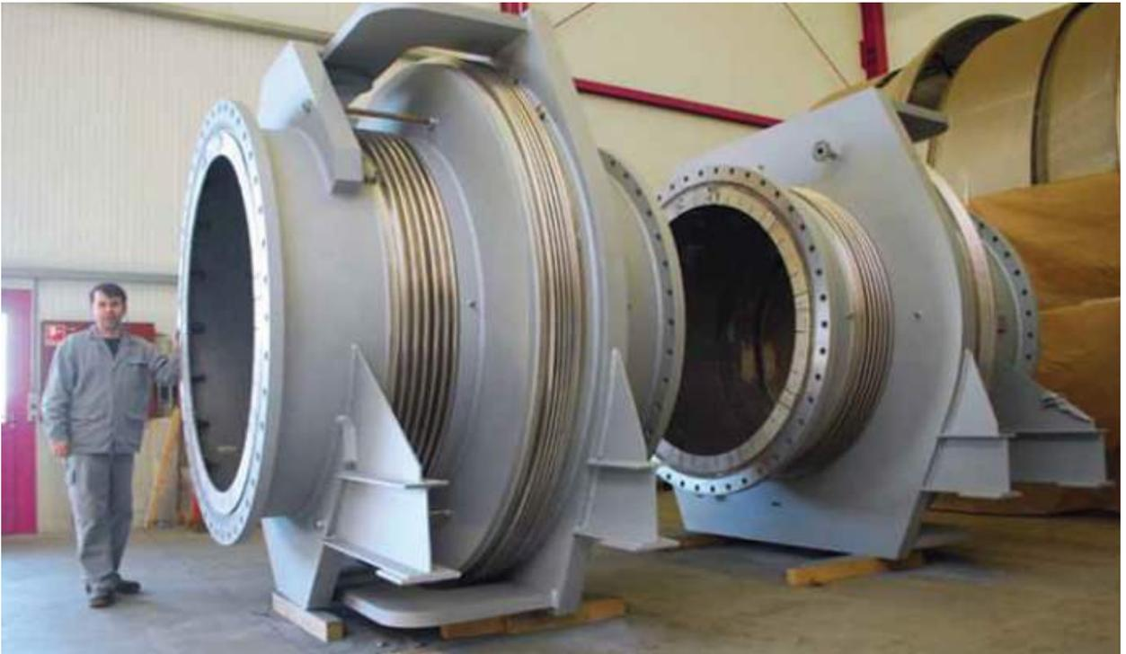
Junta de Expansión de presión equilibrada, con capa interna en Incoloy 625
