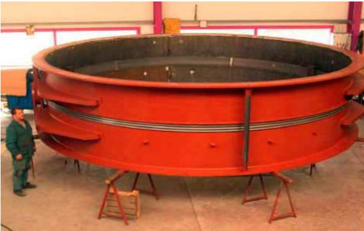
Junta de Expansión Angular DN para circuito de enfriamiento
