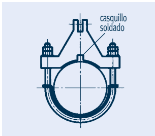
Abrazadera de ajuste por forma (dinámica)
