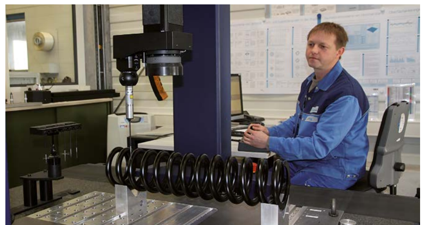
Pruebas en resortes durante la recepción del material
