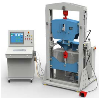
Prueba de un soporte colgante de carga constante en un banco de pruebas de 120 kN de LISEGA
