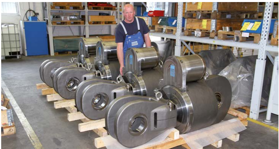
Inspección final de amortiguadores hidráulicos tipo 31
