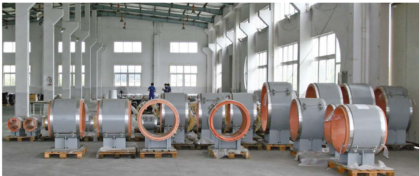
Soportes para tuberías con aislamiento premontados
