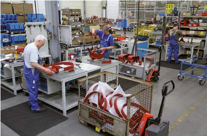
Premontaje de cadenas de soporte
