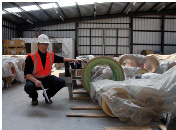
Inspección final de patines con abrazadera criogénicos
