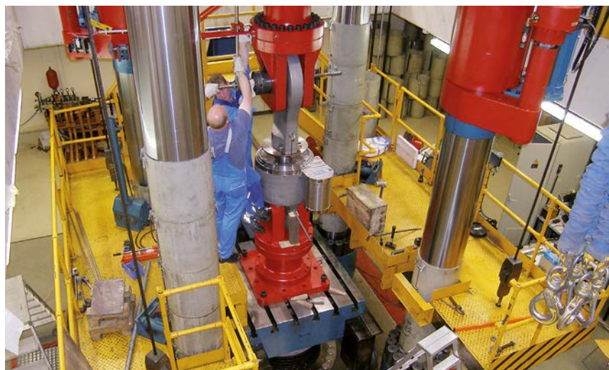
Pruebas especiales de amortiguadores hidráulicos tipo 31 Prueba de carga hasta 8600 kN.
