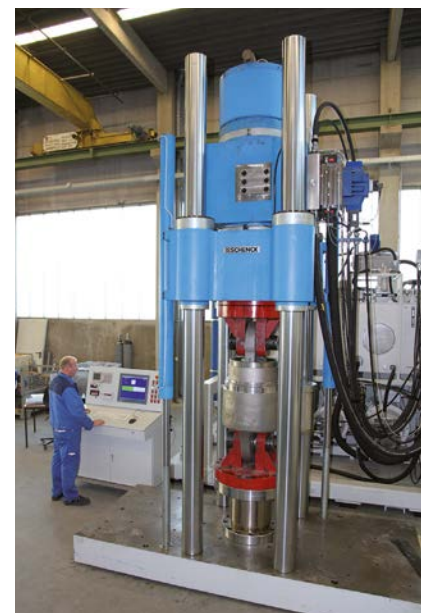
Banco de pruebas de 2500 kN de LISEGA
