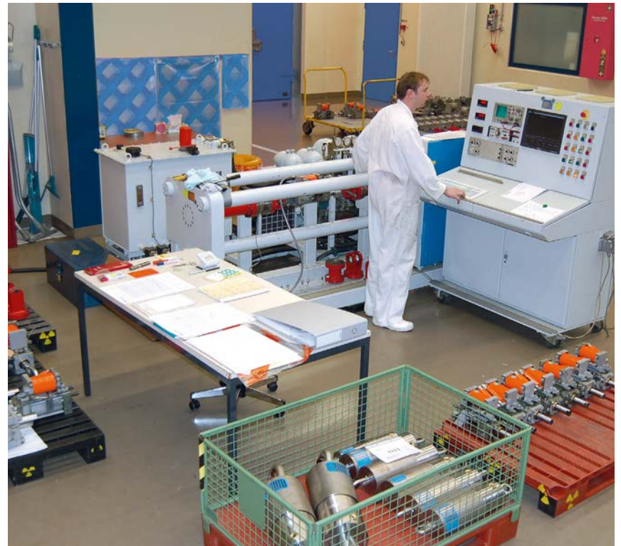
Prueba en la planta de amortiguadores hidráulicos de diferentes marcas utilizando un banco de pruebas móvil de LISEGA
